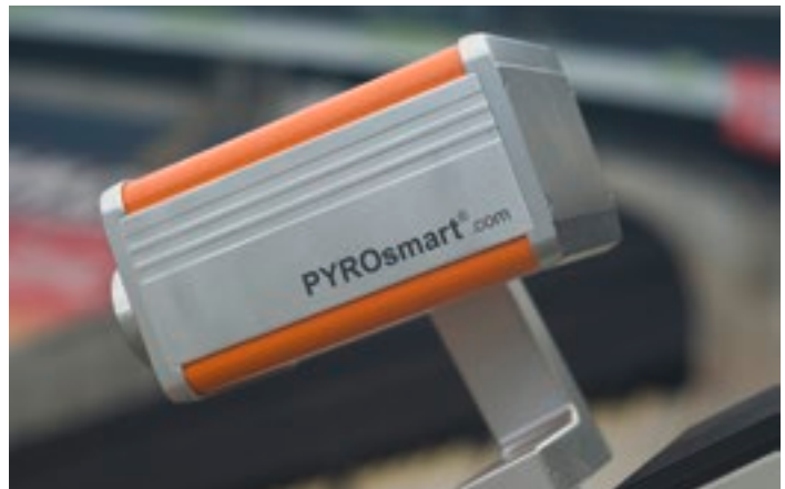
Integriert in spezielle Gehäuse: Das System arbeitet mit einer Infrarot- und einer Wärmebildkamera und ist mit einem Schwenk-Neigeantrieb ausgestattet
