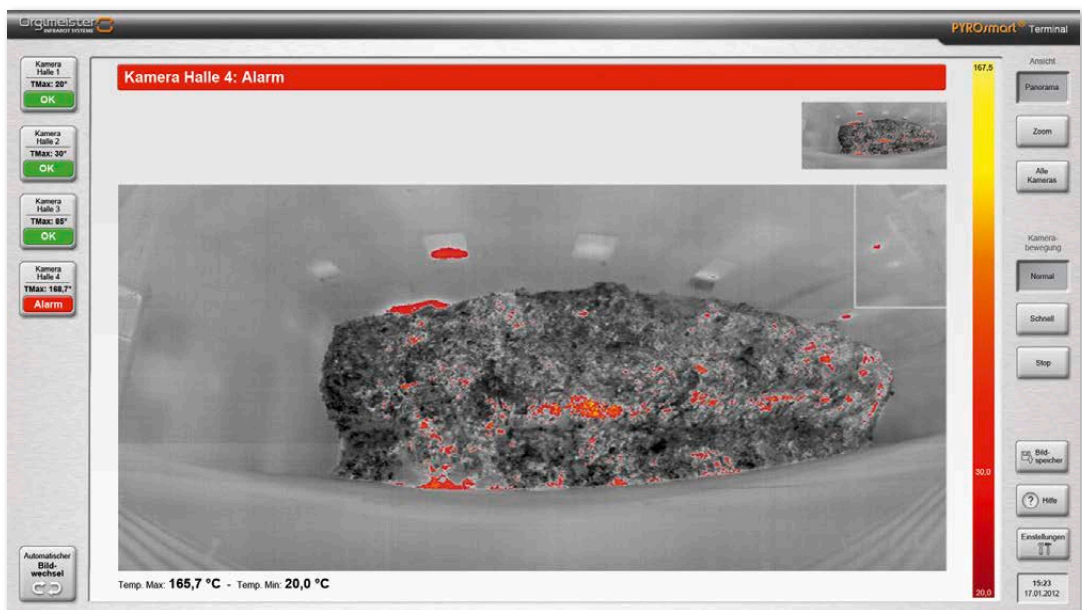
Панорамное инфракрасное отображение мусорного бункера и меню управления на сенсорном экране
