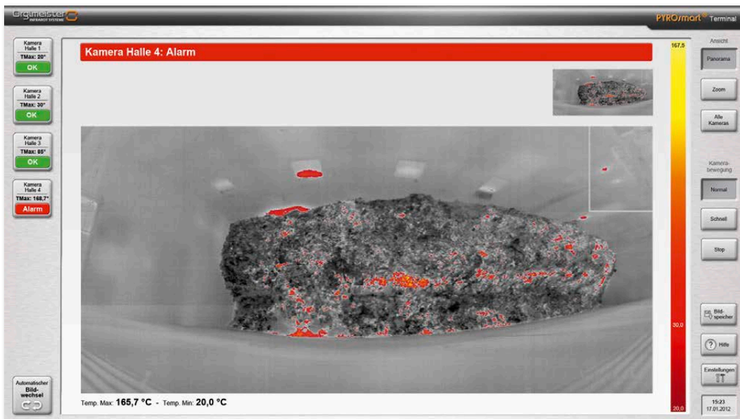
Panoramyczna wizualizacja termiczna bunkra odpadowego i obsługa za pomocą ekranu dotykowego
