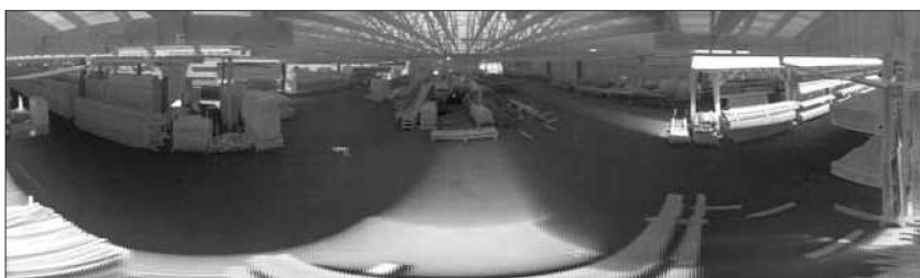
Mittels Infrarot (IR) werden mögliche frühzeitig Brandherde erkannt. Das IR-Panorama gibt dabei einen optimalen Überblick und macht gefährliche Hotspots sofort sichtbar. Fotos: Orglmeister
