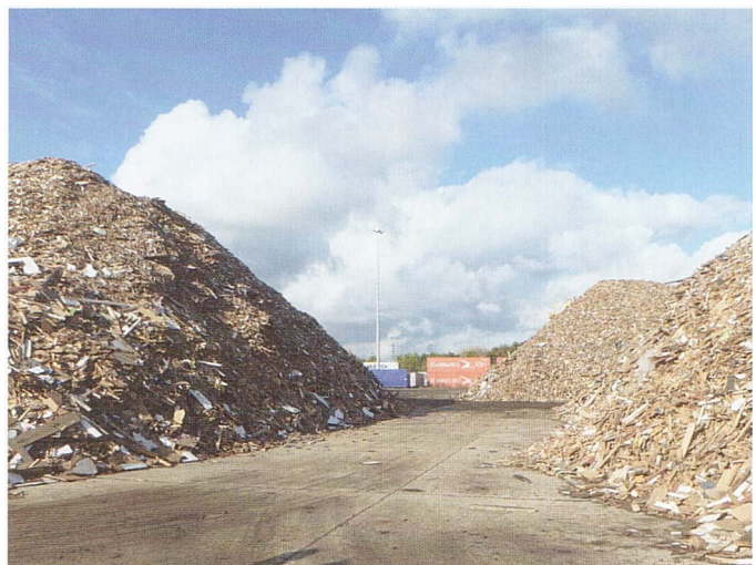
Ein Außenlager mit Ersatzbrennstoff aus Holzrecycling-Material birgt eine hohe Brandgefahr.
