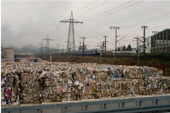
Ein Altpapierlager auf einer Freifläche lässt sich mit herkömmlichen Brandmeldern praktisch nicht überwachen
