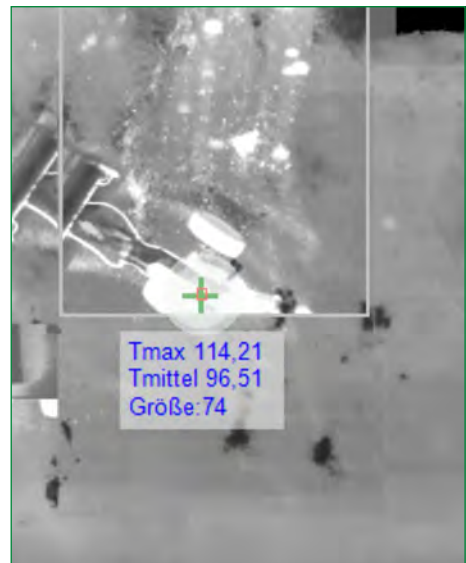
Bild 7: Erkennung einer Störgröße (Auspuff); die Temperaturschwelle für die Brandfrüherkennung liegt bei 85 °C; der Auspuff (hier gerade 114 °C) löst trotzdem keinen Brandalarm aus
