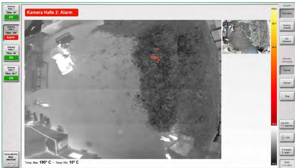
Bild 9: Beispiel einer Benutzer-Oberfläche eines Infrarot-Branderkennungssystems
