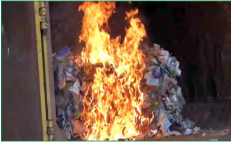
Bild 2: Brandversuch mit Ersatzbrennstoffen
